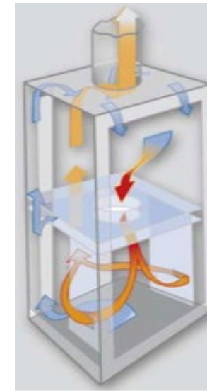
图6： 颗粒排放优化的双膛火炉中的空气和烟气流动
