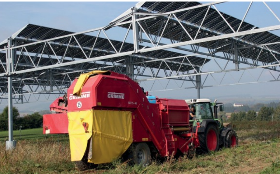
图 37：农业光伏设施下空间可供马铃薯收割机耕作 © 黑格尔巴赫农场社区
