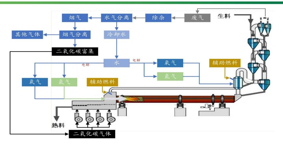
■ 采用氢能烧成技术,CO2降低约32%,窑尾废气CO2浓度可提高至95%
