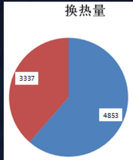
烟气余热回收系统每小时可回收 8110KW热量，折算标煤后为 1.4t/h，按年运行时间 7000h 计算，烟气余热回收系统每年可节省标9800t，每吨标煤1000元计算，烟气余热回收系统每年可节约 980万元。
