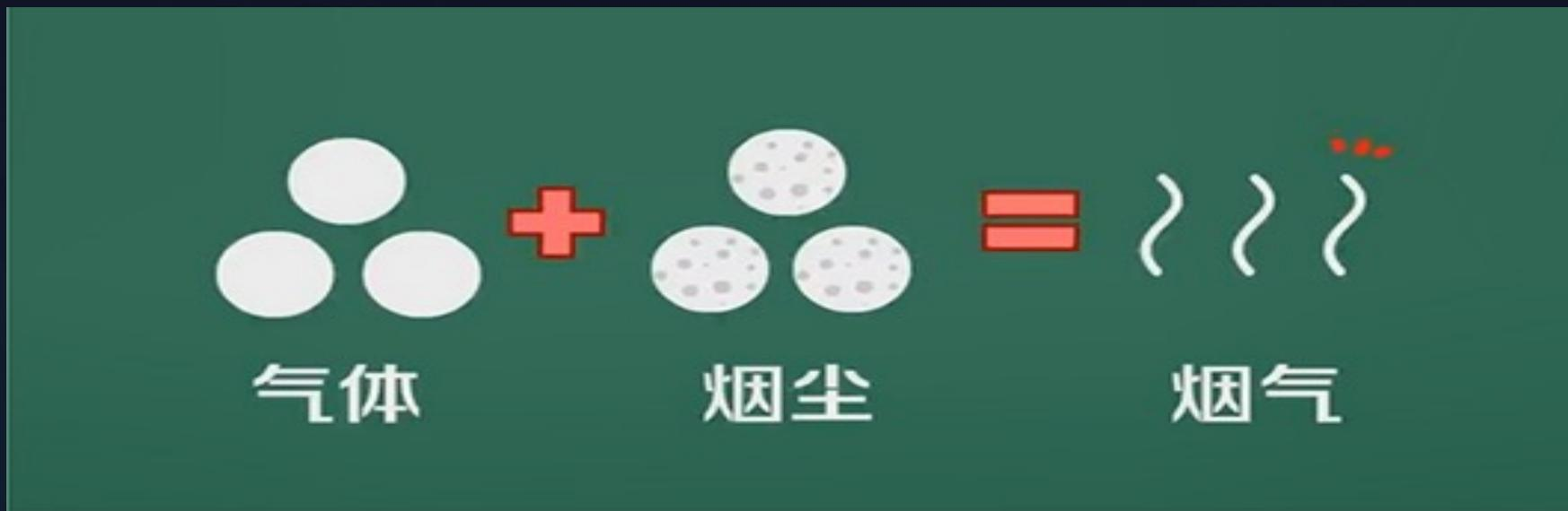
烟气混合物主要成分为 $N_2$ 、 $O_2$ 、颗粒物、 $CO_2$ 、 $SO_2$ 、氮氧化物( $NO_x$ )、水蒸气等，另外还可能含有 $CO$ 、 $SO_3$ 、 $H_2$ 、 $CH_4$ 、 $SH_2$ 、 $HF$ 和其他烃类化合物、挥发性有机化合物等，与燃料和燃烧过程密切关联，烟气排放是导致大气污染的主要原因之一。
